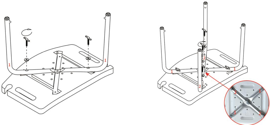
2. Соедините основной каркас с опорными ножками и отрегулируйте на одинаковую высоту.
